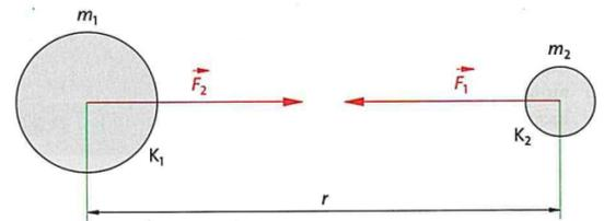
73.2 Gravitationsgesetz. Der Körper  $K_1$  zieht den Körper  $K_2$  mit der Kraft  $\vec{F}_1$  an, die gleich groß, aber der Kraft  $\vec{F}_2$  entgegengesetzt gerichtet ist, mit der  $K_2$  seinerseits  $K_1$  anzieht.
